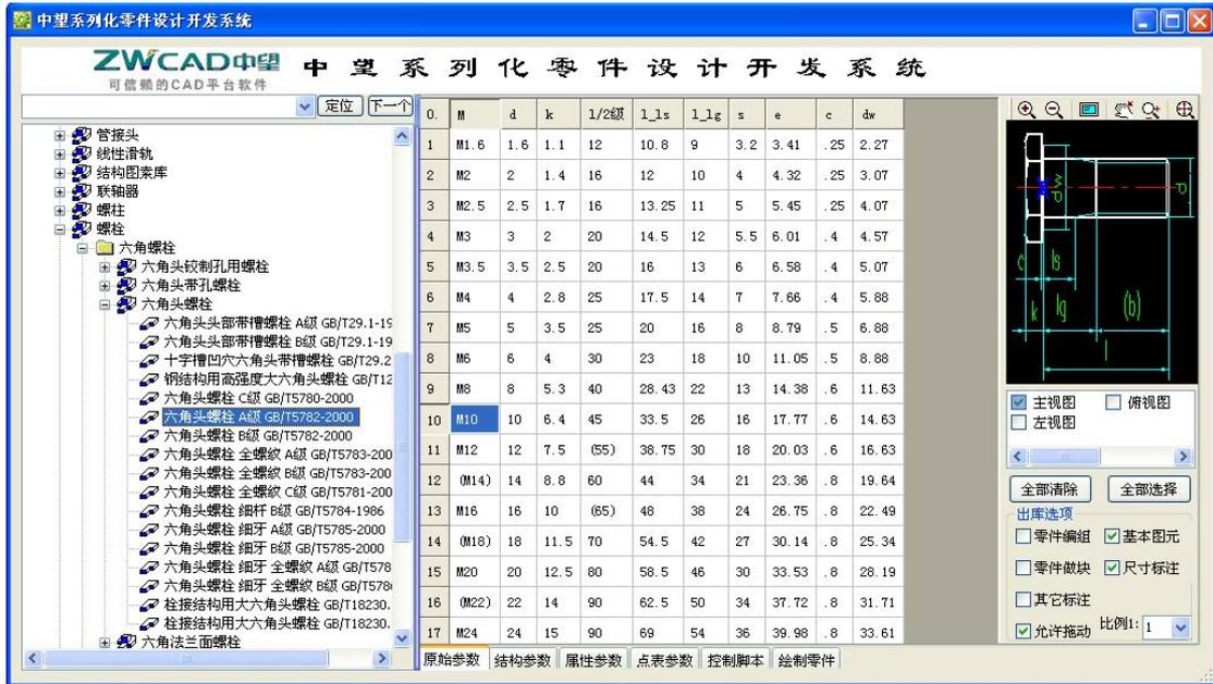
在左側的零件列表中選擇“螺栓”→“六角螺栓”→“六角頭螺栓”→“六角頭螺栓 A 級 GB/T5780-2000”，在型號中選擇“M12”，L/2 級別選擇“55”，右側的圖形預覽中可查看零件的各種視圖的縮略圖及各標注內容及各個視圖的選項開關，出庫的各種選項內容等，這裏只選擇“主視圖”，且不勾選“尺寸標注”，點擊“繪製零件”，幾秒鐘後，螺栓被繪製出來，
