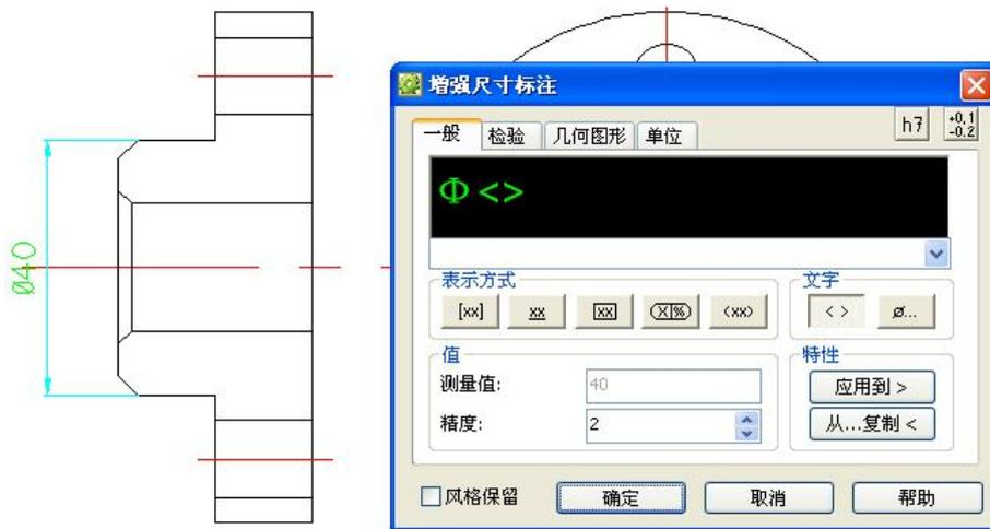
點擊“確定”，外輪廓的直徑尺寸標注完畢，此時命令處於“智慧標注”的初始執行狀態，按提示選擇零件的內輪廓的兩個點，將尺寸線位置移動至剛剛標注尺寸線位置上，此時剛剛標注的尺寸線呈“輪廓拾取”狀態，如圖：
