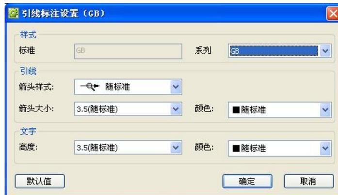
在“設置”中可設定引線標注的引線箭頭樣式、大小、顏色及文字的高度、顏色等內容。設置完畢後點擊“確定”；
