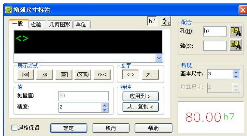
對話方塊右下角處點擊“選擇配合類型”，選擇需要的配合類型後，點擊“確定”，標注完成，結果如圖：
