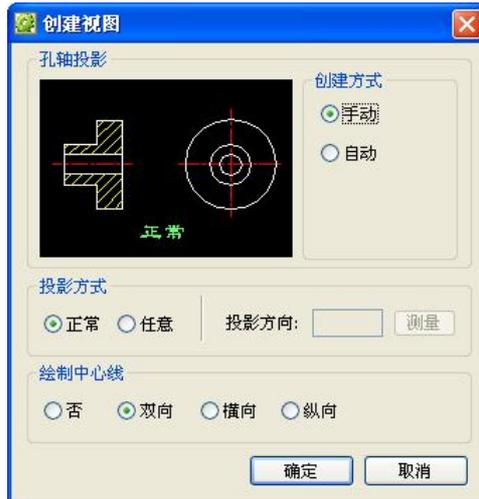
設置“手動”，投影方向“正常”，繪製中心線“縱向”，點擊“確定”；
