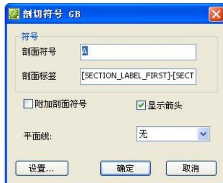
可在對話方塊中設置“剖面符號”、“剖面標籤”等內容，設置完畢後點擊“確定”；
