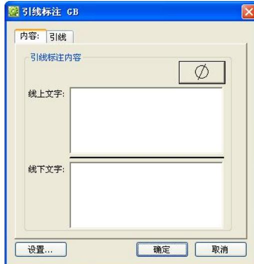
在“引線標注內容”中可添加“線上文字”和“線下文字”，同時也可以在點擊上方的“符號”按鈕添加符號內容，點擊左下角“設置”，可進入引線標注符號設置，如圖：
